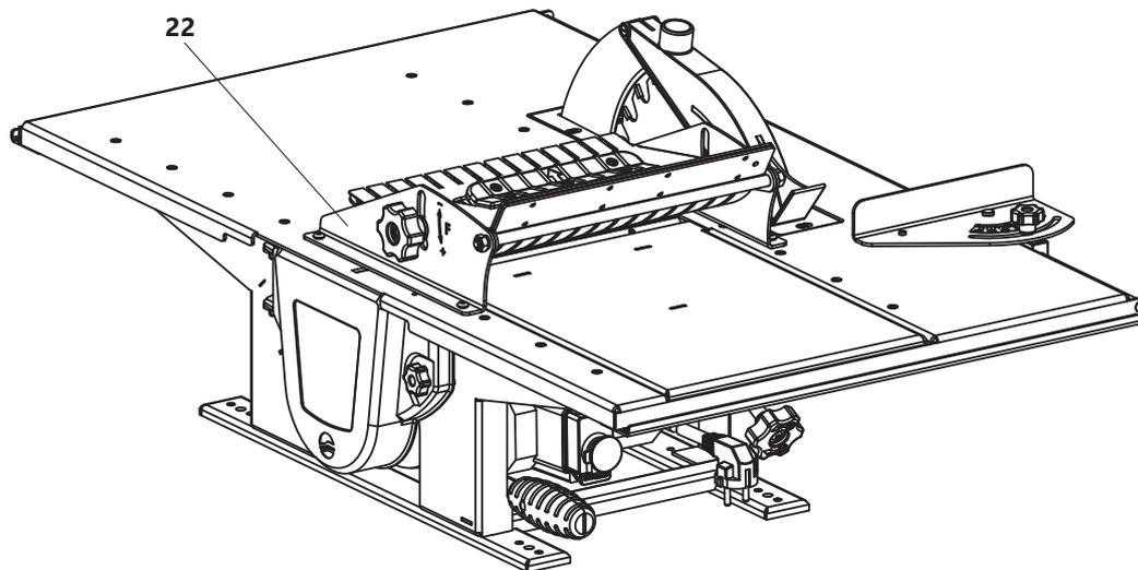
Рисунок 4. Общий вид станка с установленным устройством прижимным
