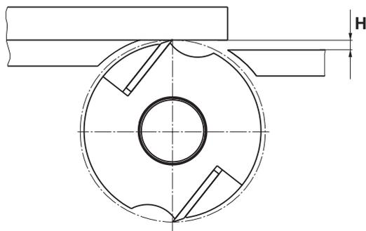
Рисунок 8. Схема регулировки ножей
